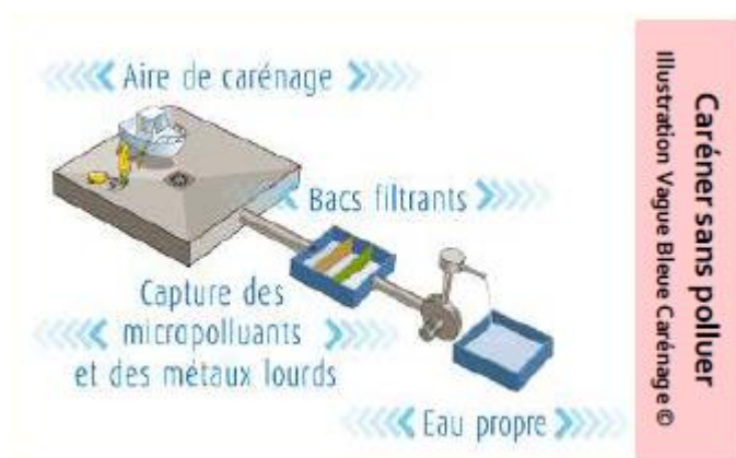
Figure 12 : Description d'une zone de carénage aux normes
