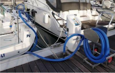
Equipement d'aspiration des eaux noires © internet
